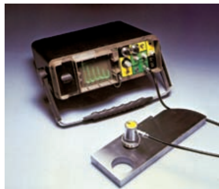
Slika 27.5 Preiskovalna sonda ultrazvočnega defektoskopa oddaja impulze ultrazvočnega valovanja. Ti potujejo skozi preiskovanec in se delno odbijejo na mejah med različnimi materiali in na napakah. Odbite impulze sprejema sonda, elektronska naprava pa jih obdela in prikaže na zaslonu. Čas med oddanim in prejetim impulzom je merilo za lego napak (npr. razpok) v materialu in za debelino merjenca.
