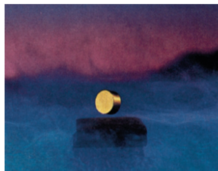
Slika 9.17 Majhen trajen magnet lebdi nad ploščo supraprevodnika.
