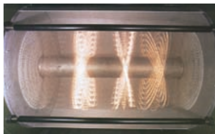
Slika 37.26 pogled v notranjost večžičnega detektorja pri eksperimentu ARGUS pri DESY v Hamburgu
