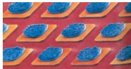
Slika 34.17 z elektronskim mikroskopom posneta vrsta IR diod
