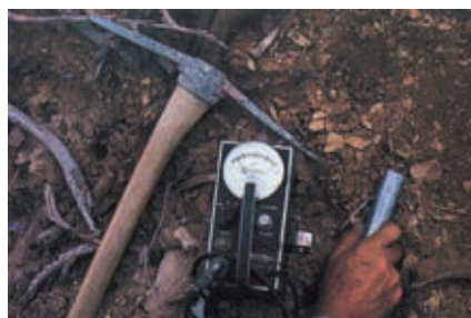
Slika 37.25 geolog išče radioaktivne elemente s prenosnim Geigerjevim števcem
