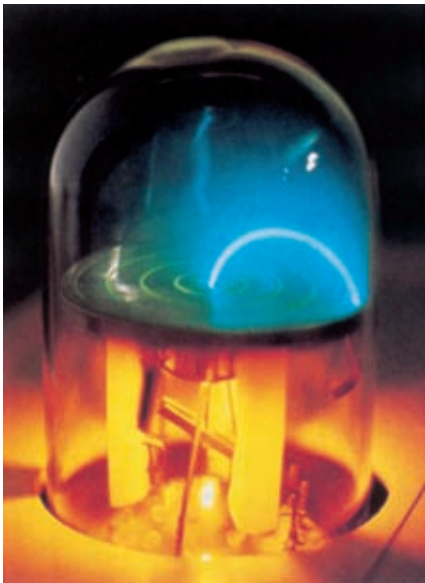
Slika 7.10 J. Thompson in njegova katodna cev. Z odklanjanjem elektronov (takrat so jih imenovali katodni žarki) v električnem in magnetnem polju je elektronom določil razmerje med nabojem in maso, e/m . Na zgornji sliki je moderna izvedba tega poskusa.
