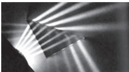
Slika 23.3 Lom svetlobe na stekleni prizmi. Na ploskev prizme vpadajo nekoliko razpršeni curki svetlobe. Na meji med steklom in zrakom se del curkov popolnoma odbije.
