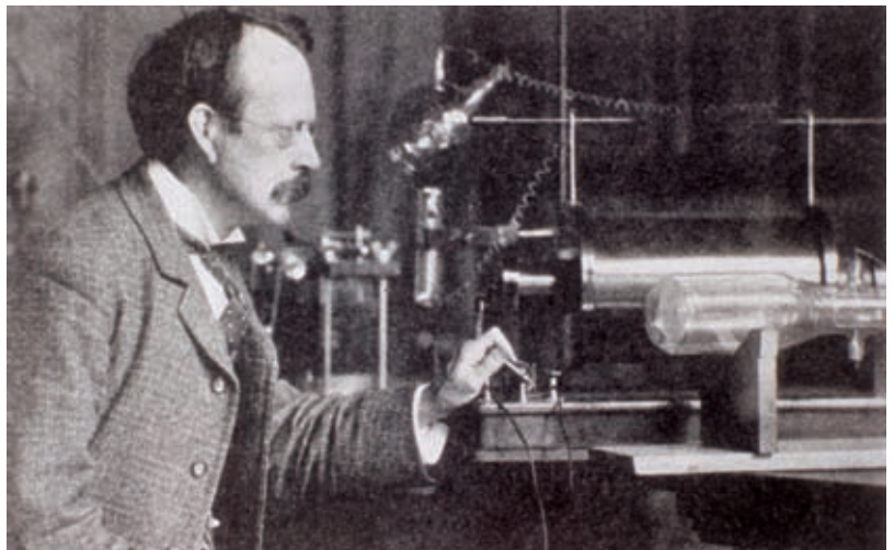
Slika 7.10 J. Thompson in njegova katodna cev. Z odklanjanjem elektronov (takrat so jih imenovali katodni žarki) v električnem in magnetnem polju je elektronom določil razmerje med nabojem in maso, e/m . Na zgornji sliki je moderna izvedba tega poskusa.
