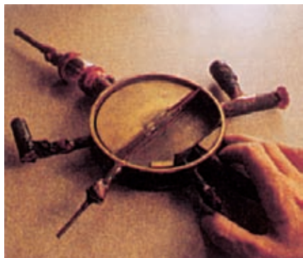
Slika 9.25 Prvi ciklotron-krožni pospeševalnik za protone je skonstruiral Lawrence leta 1932. Velik je bil toliko kot človeška dlan.
