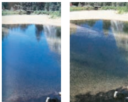
Slika 30.12 Na fotografiji na desni, ki je bila posneta z uporabo polarizatorja, lahko razberemo podrobnosti z rečnega dna. Na levi fotografiji, ki je bila posneta brez polarizatorja, moti svetloba, odbita od gladine.
