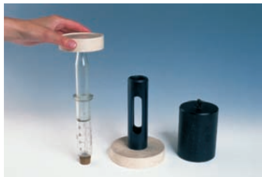
Slika 5.10 Injekcijska brizga, na katero položimo utež.
