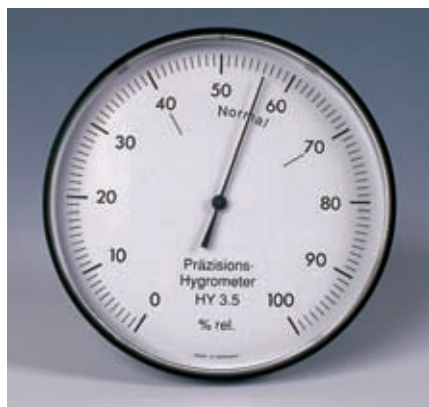
Slika 15.12 Higrometer na las kaže relativno vlažnost.
