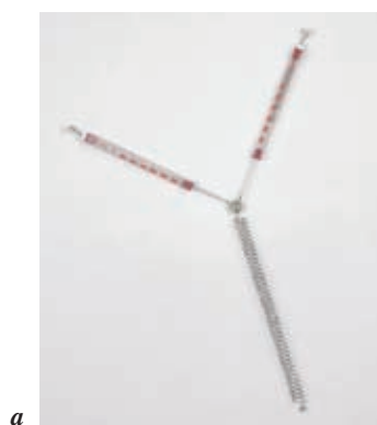
Slika 3.10 Prožno vzmet raztegujeta sili vzmetnih tehtnic(a). Sili nadomestimo z eno samo (b).
