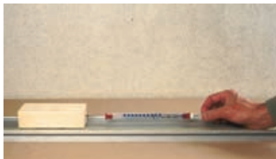
Slika 3.25 a Leseno klado enakomerno vlečemo po podlagi.
