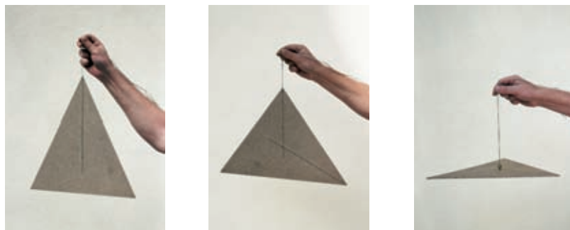
Slika 4.11 Določanje težišča s pomočjo težiščnic.
