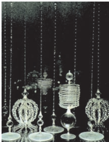
Slika 15.4 Ene najzgodnejših termometrov je izdelala Academia del Cimento (1657–1667) v Firencah.
