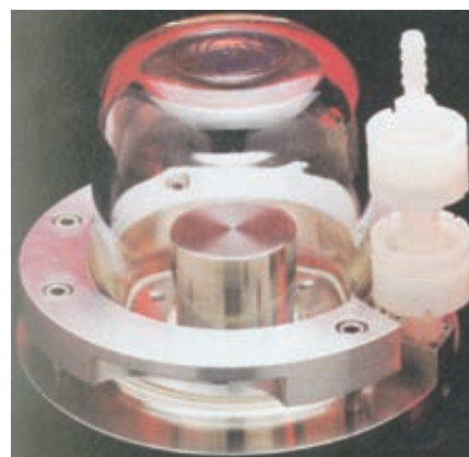
Slika 1.2 Prakilogram, utež iz platine in iridija, hranijo v mednarodnem uradu za mere in uteži v Sèvresu pri Parizu. Imel naj bi maso litra kemijsko čiste vode pri temperaturi 4^\circ \text{C} .
