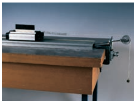
Slika 7.1 Voziček na vodoravnem tiru se giblje pospešeno zaradi sile vrvice.
