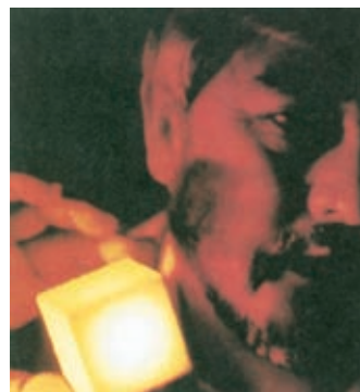
Slika 16.5 Kocko iz posebnega materiala lahko držimo v roki kljub temu, da je segreta na 1260°C. Iz tega materiala so bile narejene krovne ploščice za vesoljsko vozilo Space Shuttle.
