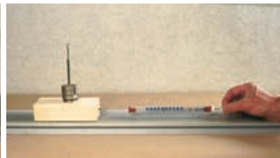
Slika 3.25 b Ko klado obtežimo, se vlečna sila poveča.
