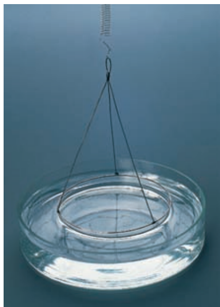
Slika 5.8 Merjenje površinske napetosti vode.
