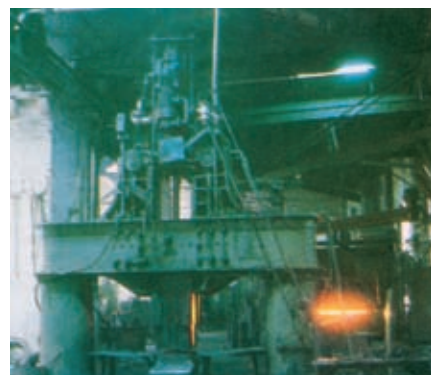
Slika 17.2 Leta 1889 so v Studencih pri Mariboru postavili parno kovaško kladivo z maso 120 ton. S strojem so izdelovali velike odkovke za popravila tirnih vozil. Je največje in najstarejše še delujoče parno kladivo v tem delu Evrope.
