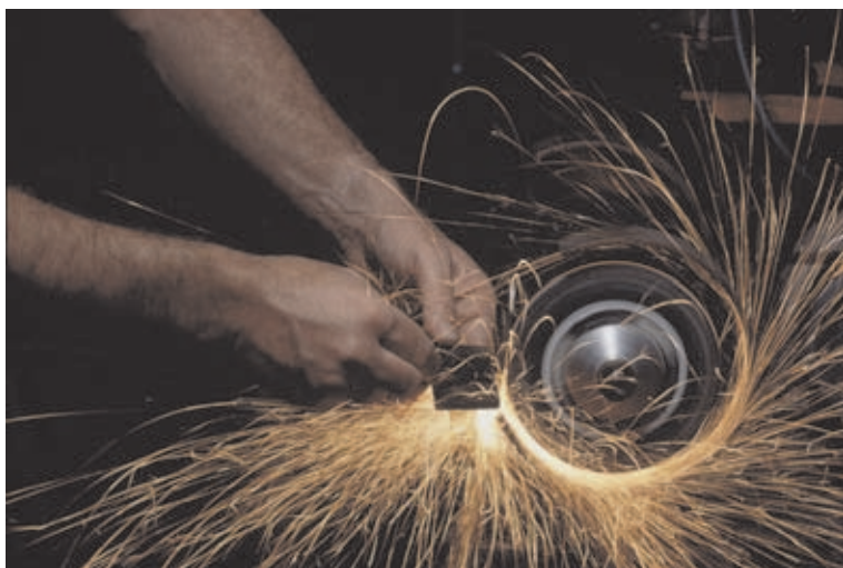
Slika 8.6 Obruski odletavajo v tangentni smeri.
