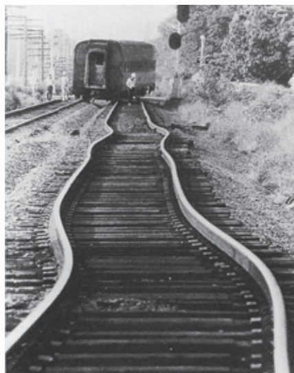
Slika 15.6 Železniške tračnice, ki so se zvile zaradi hude vročine.
