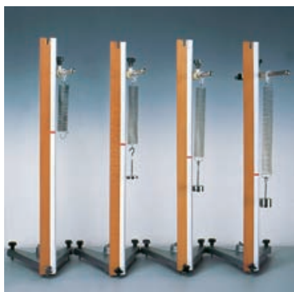
Slika 3.8 Umerjanje vijačne vzmeti.
