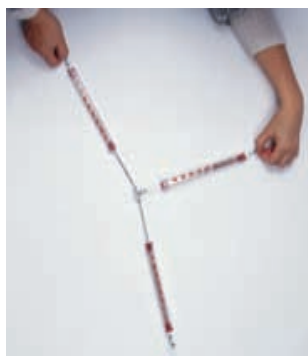
Slika 3.14a Obroček, ki ga vlečejo vsaksebi tri vzmetne tehtnice, je v ravnovesju.
