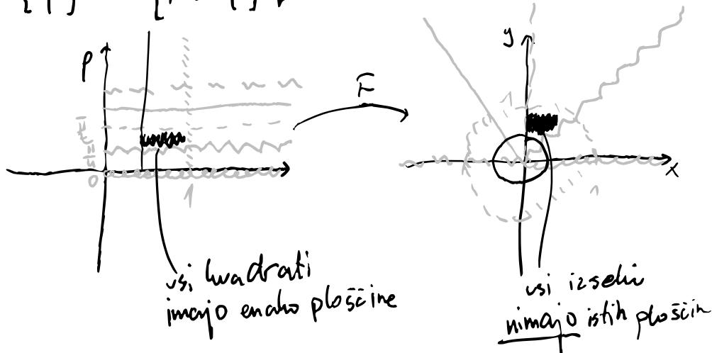
$$JF = \begin{bmatrix} \cos \varphi & -r \cdot \sin \varphi \\ \sin \varphi & r \cdot \cos \varphi \end{bmatrix} \quad \det(JF) = r \cdot \cos^2 \varphi + r \cdot \sin^2 \varphi = r$$
